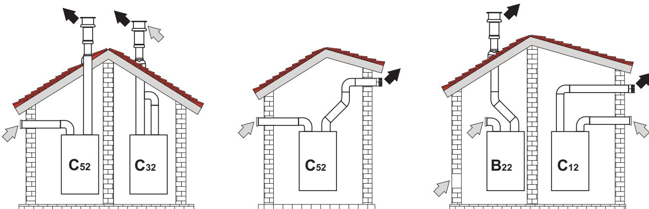
obr. 23 - Príklady spojenia oddelenými rúrkami (➡ = Vzduch / ➡ = Dym)
