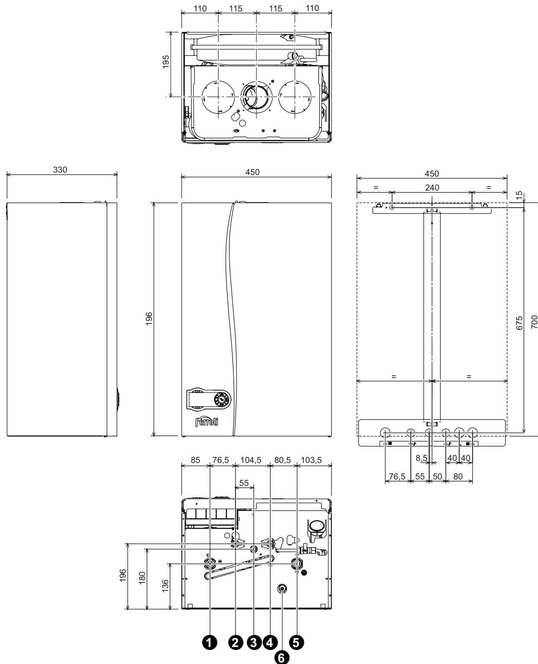
obr. 30 - Rozměry a přípojky
