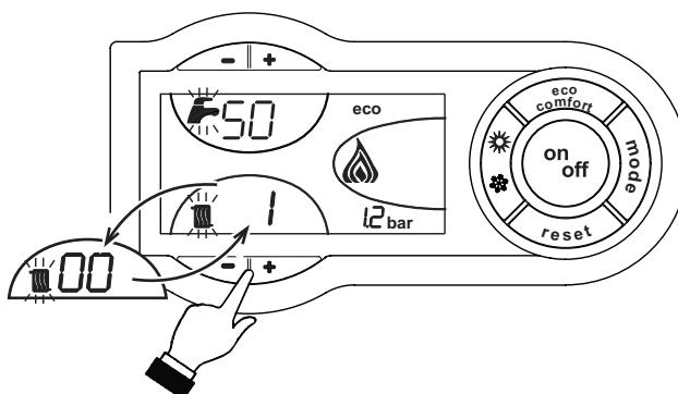
рис. 26 - Режим TEST (мощность отопления = 100%)
