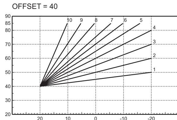
obr. 15 - Príklad paralelného premiestnenia kompenzačných kriviek
