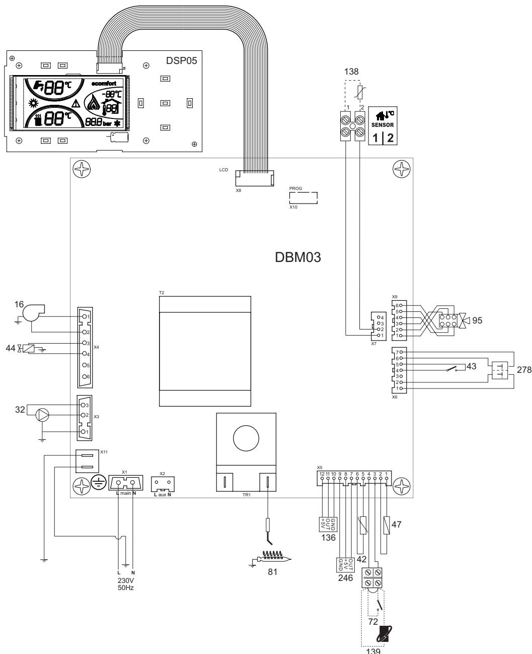
obr. 33 - Elektrické schéma
