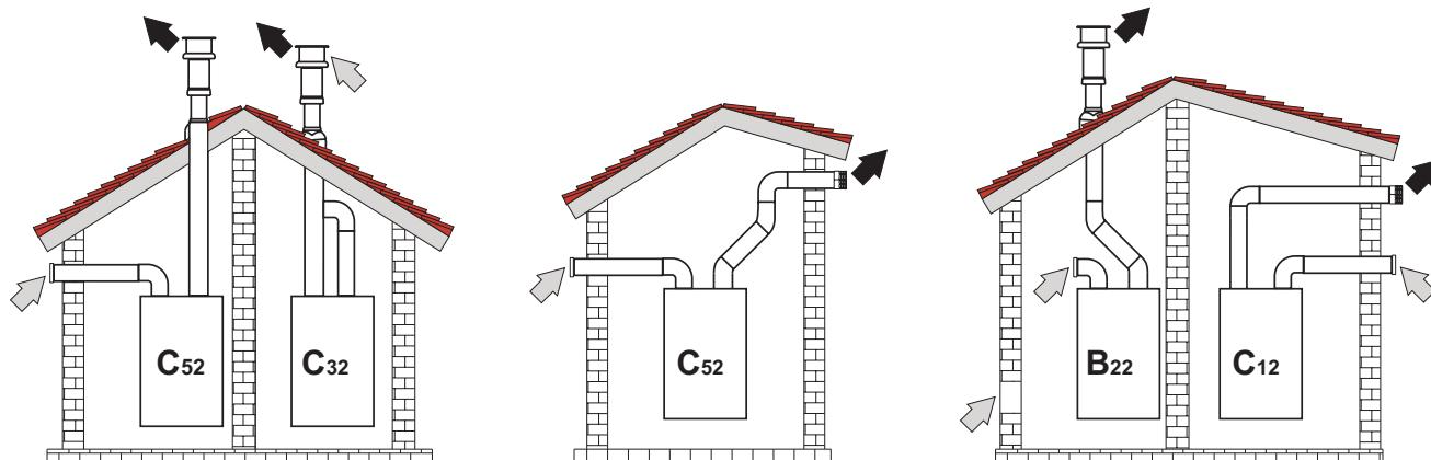
ábra 23 - Példák külön csövekkel történő bekötésére (➡ = Levegő / ➡ = Füst)
