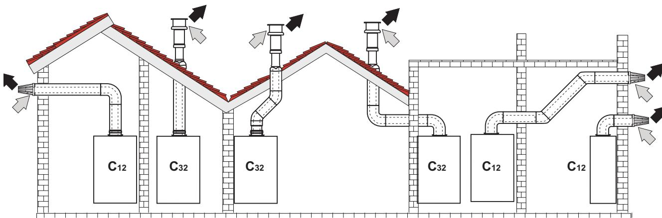
ábra 21 - Példák koaxiális csövekkel történő bekötésére (➡ = Levegő / ➡ = Füst)
