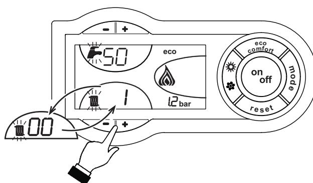
obr. 26 - Režim TEST (výkon vykurovania = 100%)
