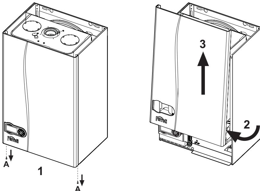
obr. 28 - Otevření pláště
