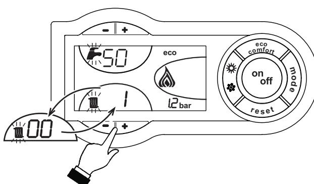
мал. 26 - Режим TEST (потужність опалювання = 100%)
