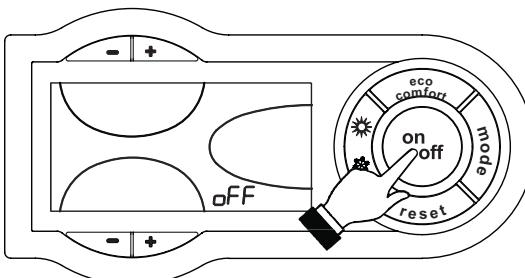
obr. 7 - Vypnutí kotle
