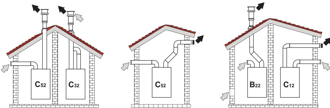
obr. 23 - Příklady připojení s oddělenými trubkami (➡ = Vzduch / ⚡ = Spaliny)
