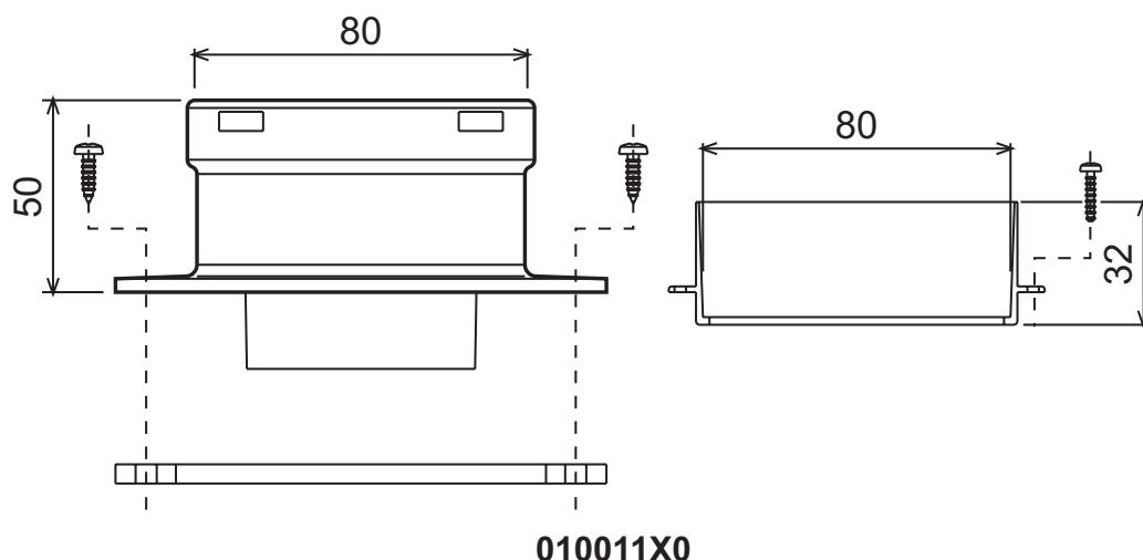
рис. 24 - Соединительный элемент для раздельных труб
