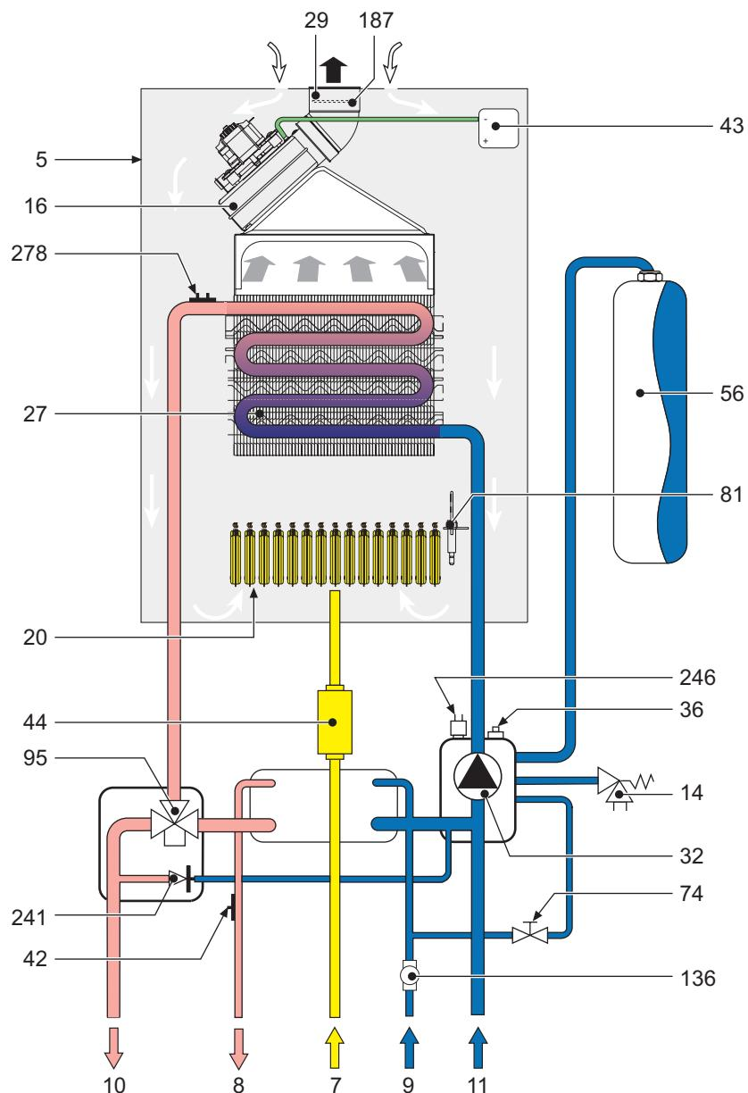
рис. 32 - Схема системы отопления и контура ГВС
