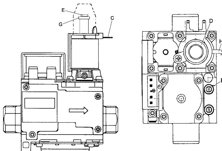
рис. 27 - Газовый клапан
