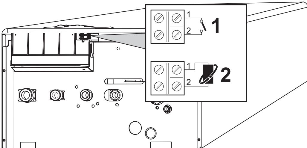
obr. 19 - Prístup k elektrickej svorkovnici
