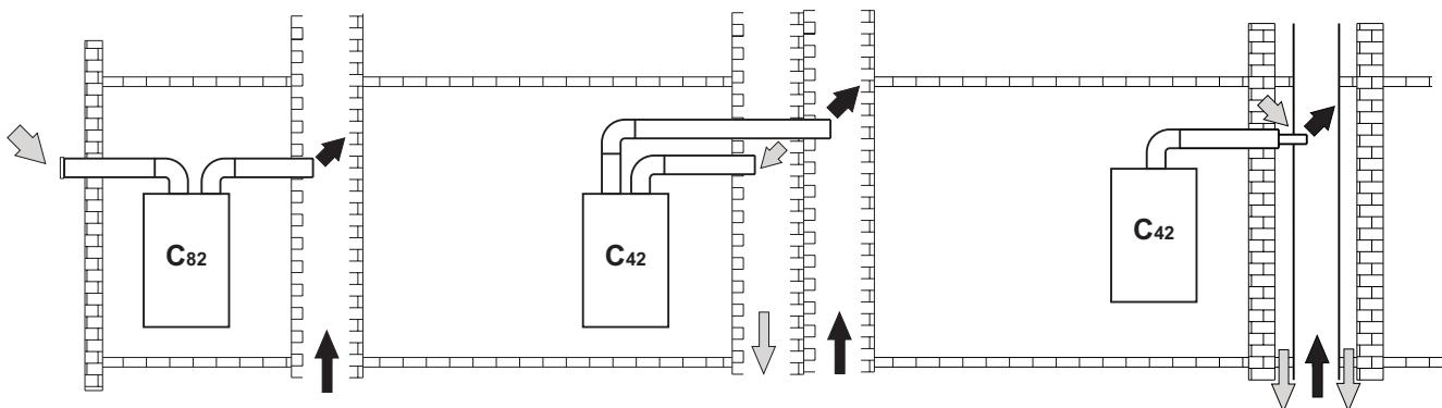
obr. 25 - Příklady připojení ke kouřovodům (➡ = Vzduch / ➡ = Spaliny)
