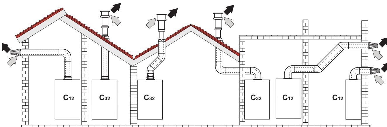
obr. 21 - Příklady připojení se souosovými trubkami (➡ = Vzduch / ➔ = Spaliny)
