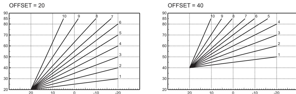
мал. 15 - Приклад паралельного зміщення кривих стиснення
