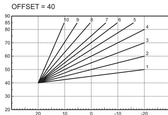
рис. 15 - Пример параллельного смещения компенсационных характеристик
