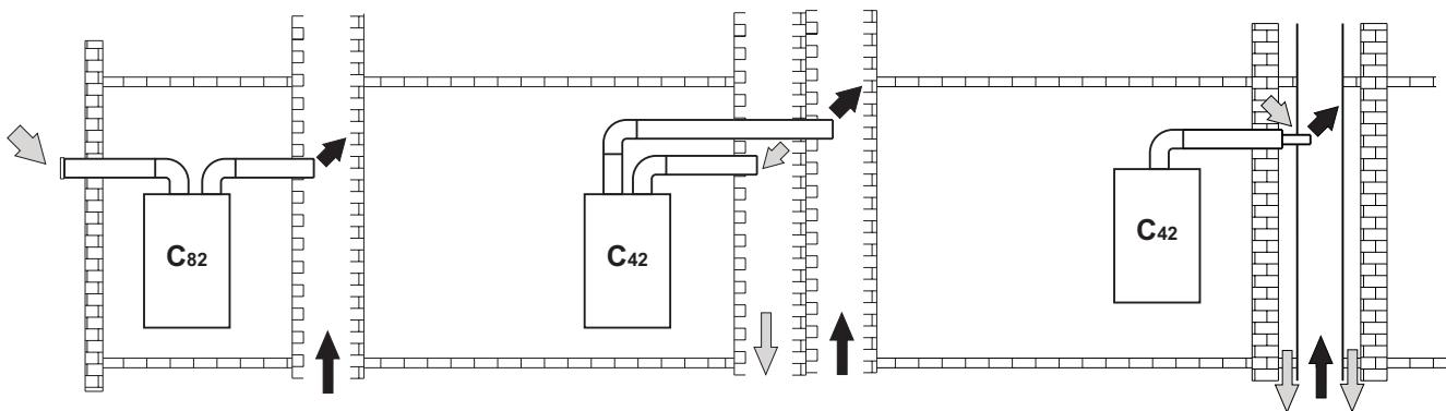
obr. 25 - Príklady zapojenia ku komínom (➡ = Vzduch / ➡ = Spaliny)
