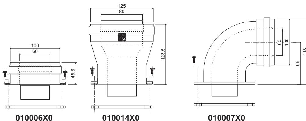
obr. 22 - Výstupní příslušenství pro souosové potrubí
