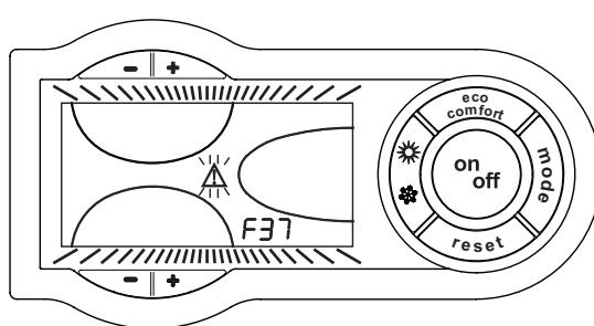
obr. 16 - Poruchu nedostatočného tlaku v zariadení
