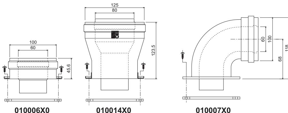
рис. 22 - Исходные элементы для коаксиальных воздуховодов
