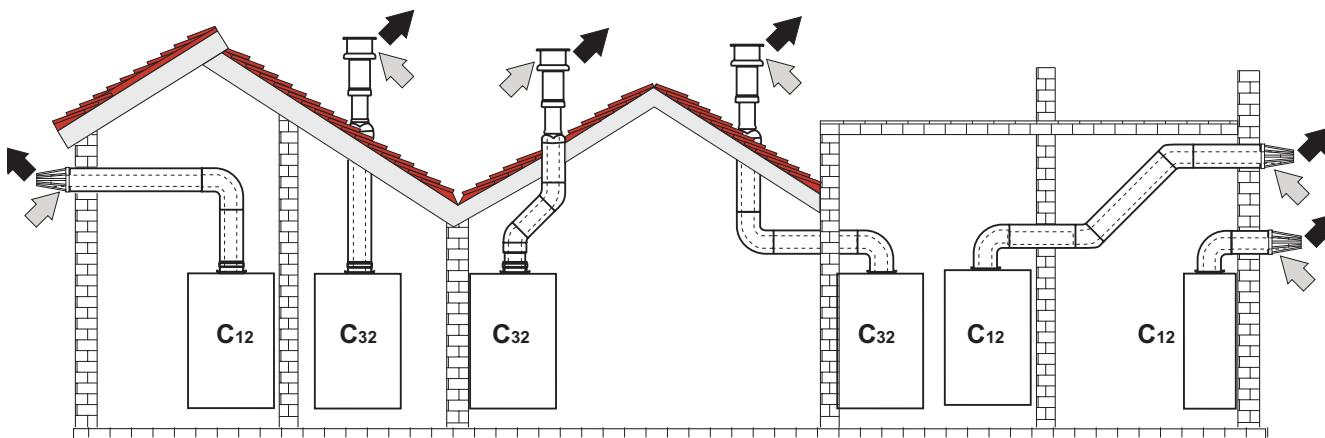
obr. 21 - Príklady spojenia koaxiálnymi rúrkami (➡ = Vzduch / ➡ = Dym)
