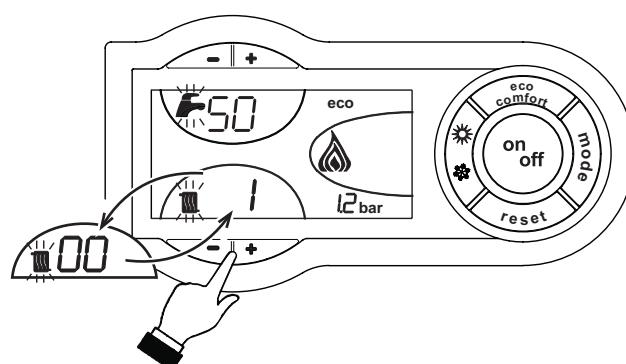
obr. 26 - Režim TEST (výkon vytápění = 100%)
