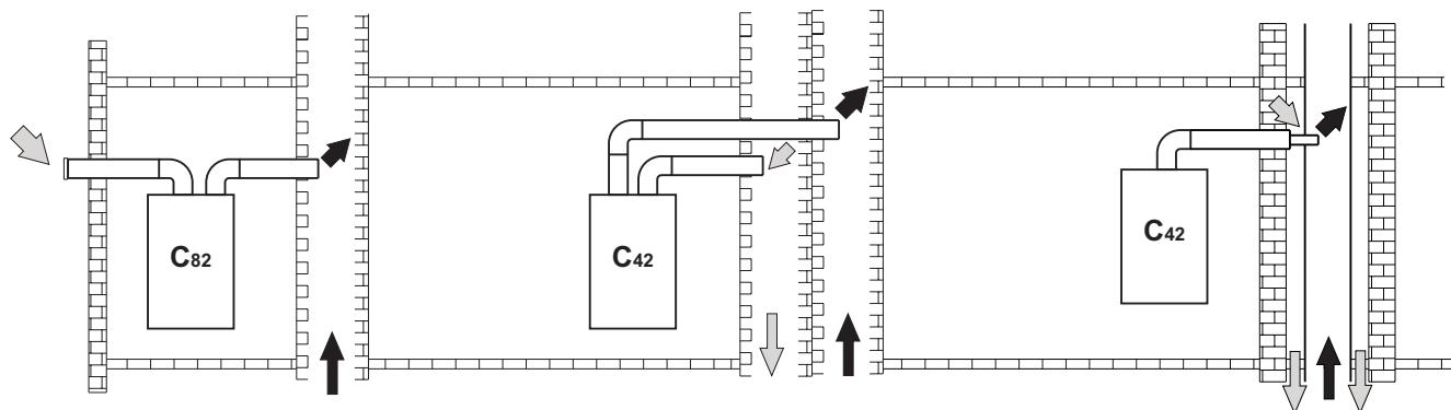
ábra 25 - Példák füstcsövekre történő bekötésre (➡ = Levegő / ➡ = Füst)
